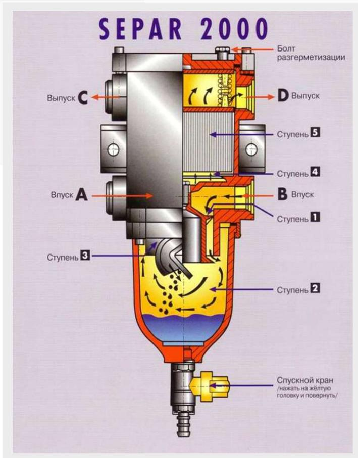
**1. Ступень.** Топливо попадая в фильтр проходит по внутренним каналам, начинает закручиваться и под действием центробежных сил грязь и вода отделяется .
